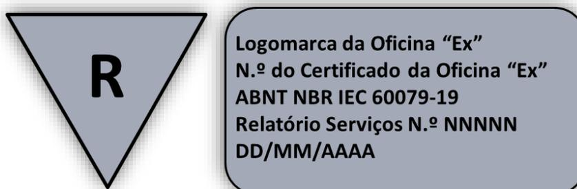
*Marcação aplicada quando os serviços de reparos ou recuperação do equipamento “Ex” se encontram em conformidade com os requisitos Norma ABNT NBR IEC 60079-19 e das Normas dos tipos de proteção “Ex”, aplicáveis para a data de fabricação do equipamento “Ex”, mas não com os documentos da certificação*
