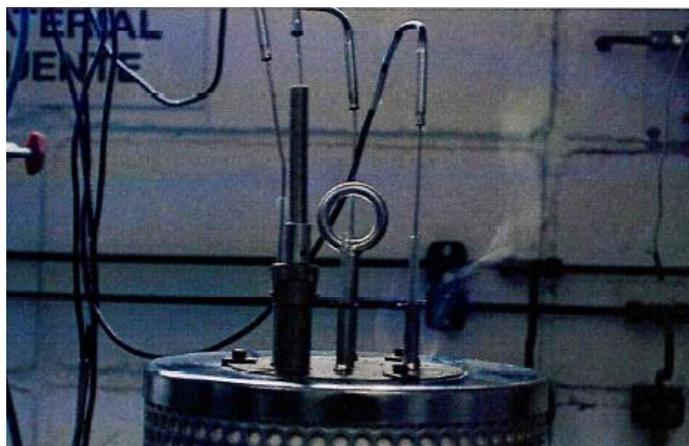
Detalhe do desprendimento de fumaça durante ensaio de Temperatura de Autoignição de poeira combustível.
