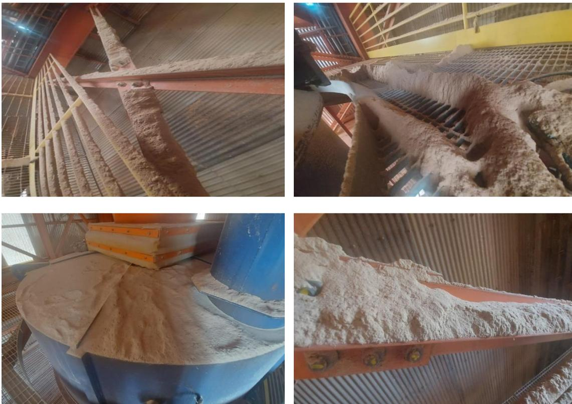
Exemplos de acúmulo de poeira combustíveis em forma de camada sobre estruturas (não aquecidas) de equipamentos de processo
