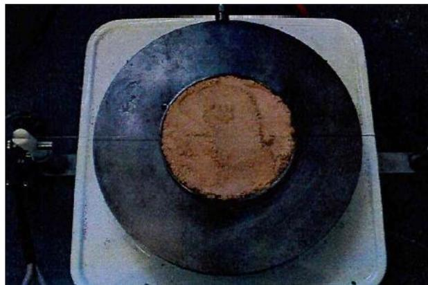
Placa aquecida para ensaios de determinação da temperatura mínima de ignição de poeira combustível na forma de camada. Fonte: CETAC (*Centro Tecnologia do Ambiente Construído*) - LFEX (*Laboratório de Segurança ao Fogo e Explosões / IPT*)
