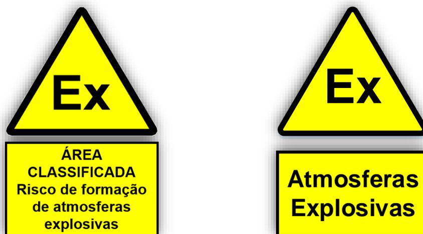
Exemplos de placa de sinalização de segurança em áreas classificadas de acordo com as Normas Técnicas Brasileiras adotadas **ABNT NBR IEC 60079-14** e **ABNT NBR IEC 61892-7**
