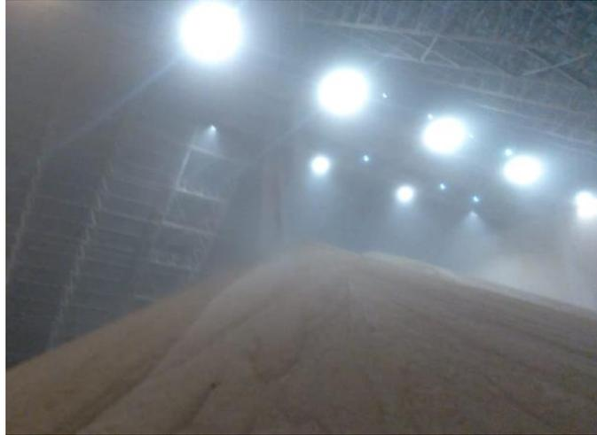
Suspensão de poeira provocada pela movimentação de farelo ou grãos de poeiras combustíveis: Formação de pilha no interior de um armazém graneleiro
