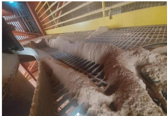
Exemplo de camada de poeira depositada sobre grades de moegas de descarregamento de farelo de soja
