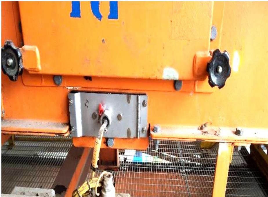
Sensor de temperatura com barra de latão para monitoramento de desalinhamento instalado em esteira rolante enclausurada para transporte de poeiras combustíveis em áreas classificadas
