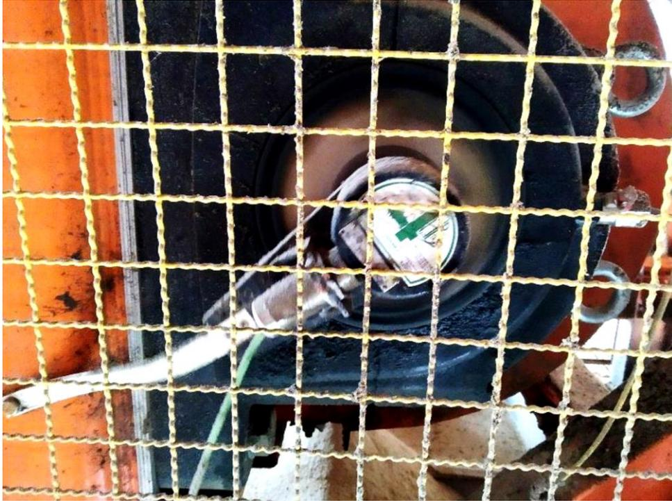
Sensor de velocidade (rotação de cilindro de acionamento) instalado em esteira rolante para transporte de poeiras combustíveis em área classificada
