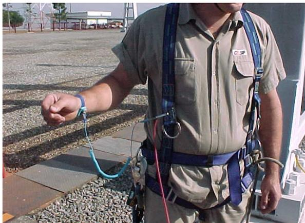
Figura 39 – Vista do técnico utilizando a pulseira flexível presa no próprio cinto e o respectivo terra de serviço.
