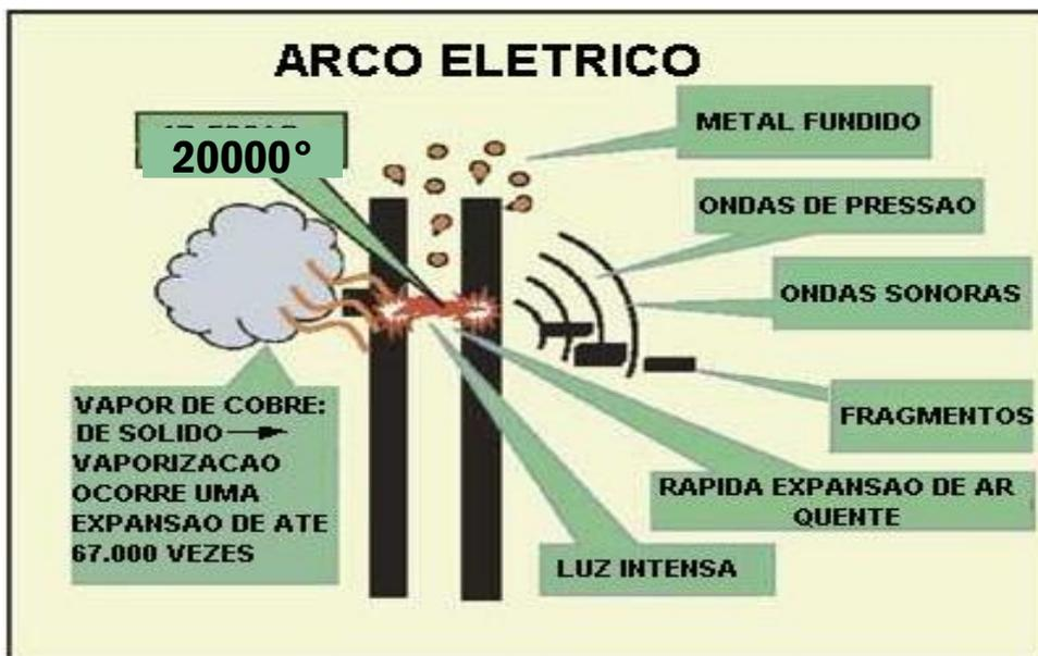
Figura 4 – Riscos do Arco Elétrico
